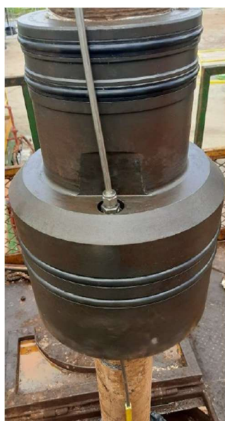
Figura 4 – Terminação do Suspensor de Coluna
