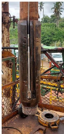
Figura 3 – Cabo fixado no mandril SGM
