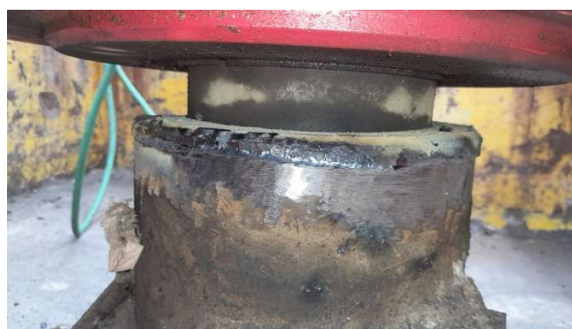
Figura 2 – Bisel e cabeça de produção Cameron
