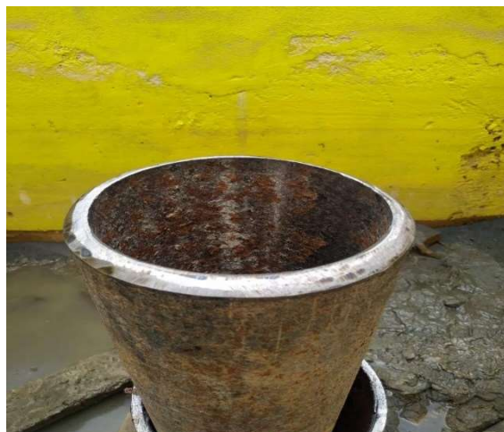
Figura 3 – Revestimento 7” Biselado
