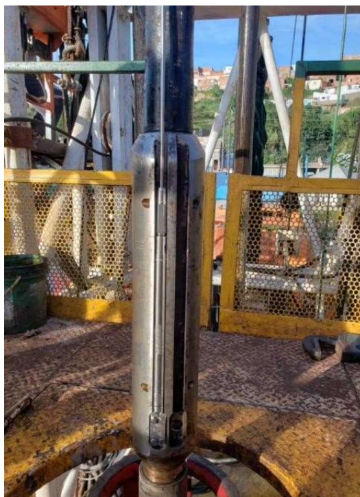
Figura 6 – Cabo fixado no tubo para teste
