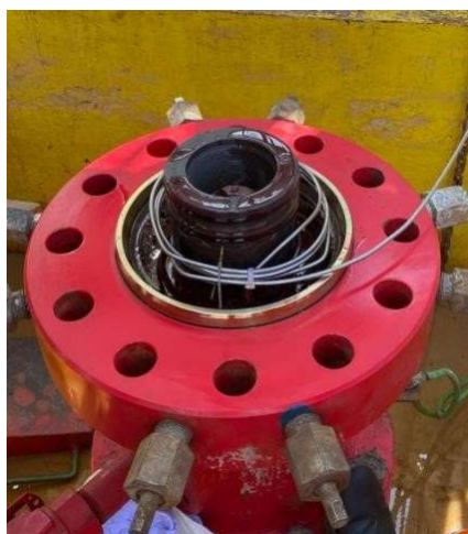
Figura 7 – Tubing Hanger
