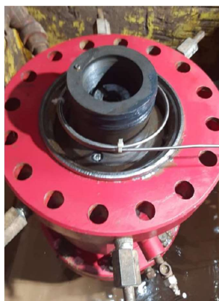
Figura 5 – Suspensor Assentado
